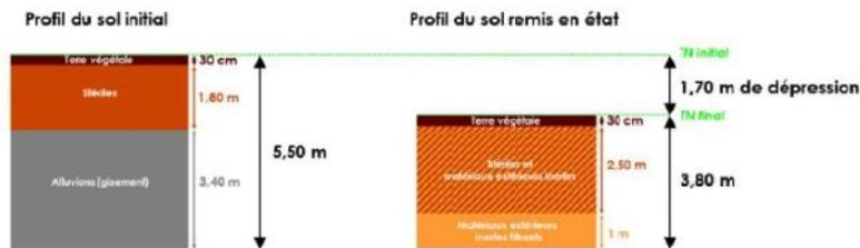
Figure 7 – coupe de remblaiement de l'excavation
